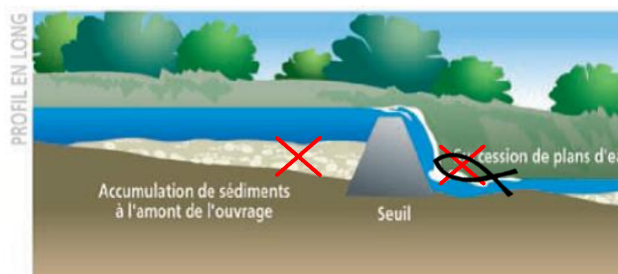
Figure 33 : Impact des ouvrages hydrauliques sur la continuité écologique
